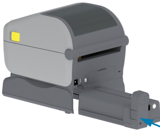
Аккумулятор готов к установке
