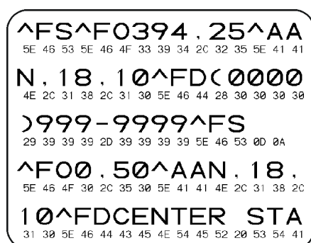
Рис. 4 Этикетка теста диагностики обмена данными
