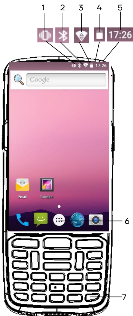
Рисунок 9. Расположение основных индикаторов изделия
