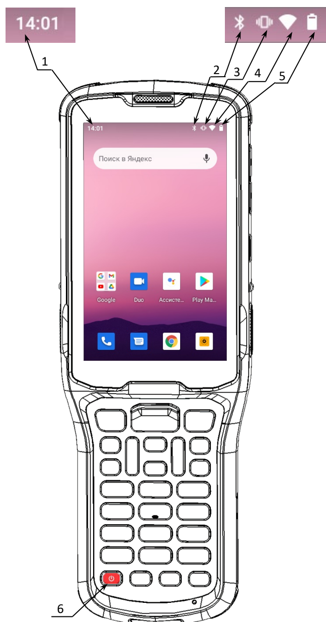
Рисунок 10. Расположение основных индикаторов изделия
