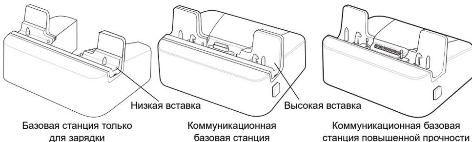
Установка базовой станции только для зарядки, коммуникационной базовой станции, блока питания, PWR5-14000-148R и 3-жильного сетевого шнура переменного тока (приобретается отдельно).
