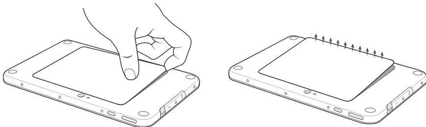
2. Аккуратно снимите крышку отсека аккумулятора с ET5X.
