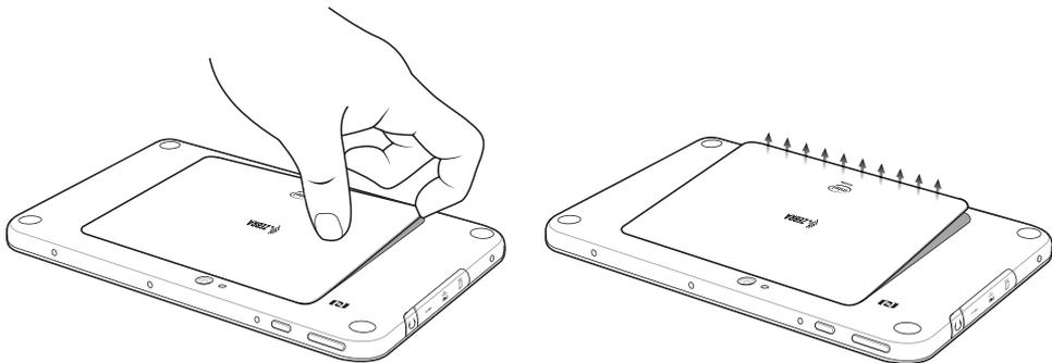
3. Аккуратно снимите крышку отсека аккумулятора с ET55.
