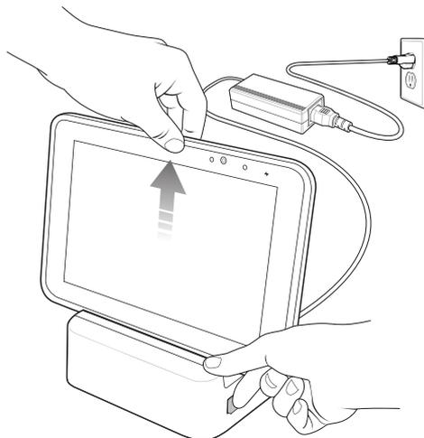
Чтобы снять ET5X с коммуникационной базовой станции, нажмите и отпустите кнопку с правой стороны базовой станции и поднимите ET5X. Удерживайте базовую станцию большим пальцем.
