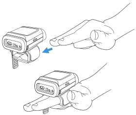
Потяните за ремешок, чтобы надежно закрепить сканер, и спрячьте остальную часть ремешка в направляющую под манжетой для пальцев.
